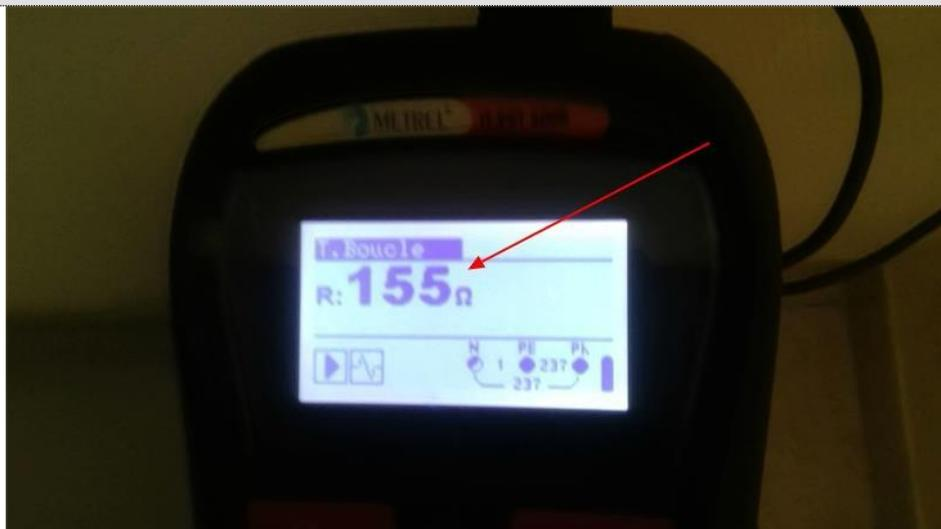
**Description :** La valeur de la résistance de la PRISE DE TERRE n'est pas adaptée au courant différentiel résiduel (sensibilité) du ou des dispositifs différentiels protégeant l'ensemble de l'installation électrique.
