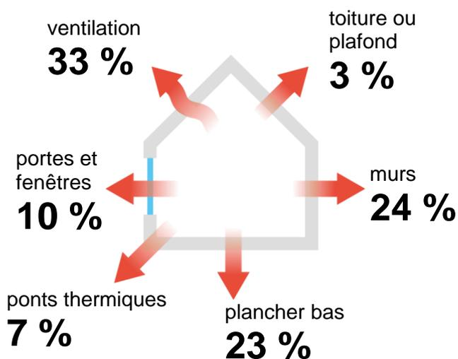
Coefficient de déperditions thermiques : 0,49 W/(m².K)
